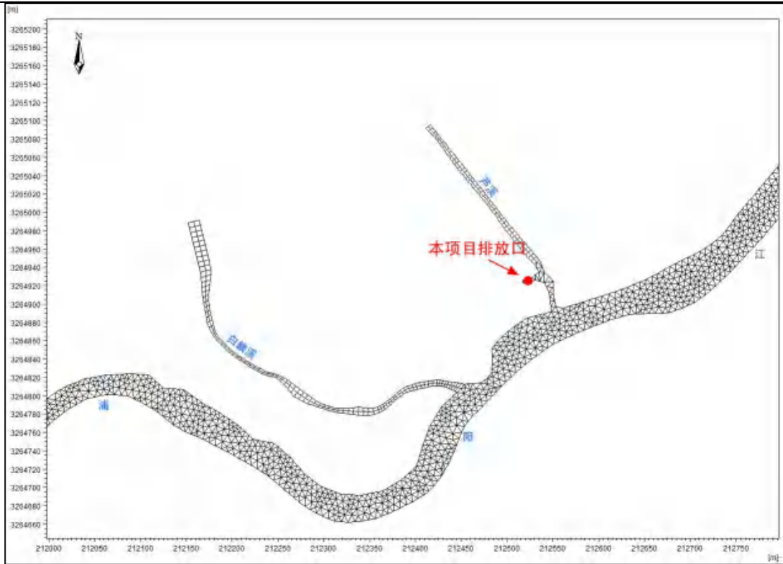
图 7.5-4 模型计算网格图（项目附近）
