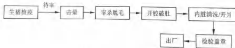
图 3.5-2 新市厂区生猪宰杀工艺流程图
